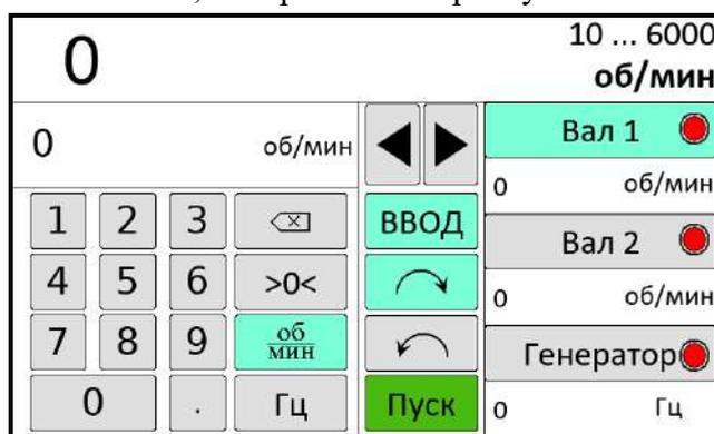
Рисунок 2 – Общий вид дисплея с сенсорной клавиатурой
