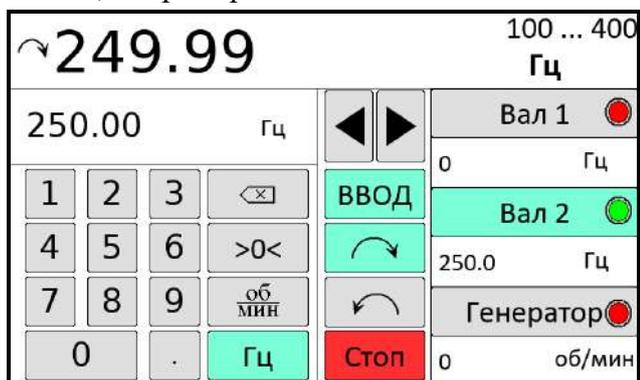
Рисунок 5 – Вид дисплея установки при включенном вале №2
