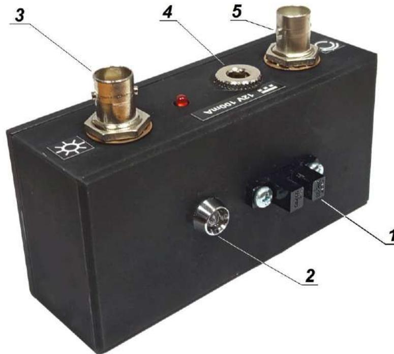
1 – оптопара; 2 – фотоприемник; 3 – разъем выхода импульсов с фотоприемника;
