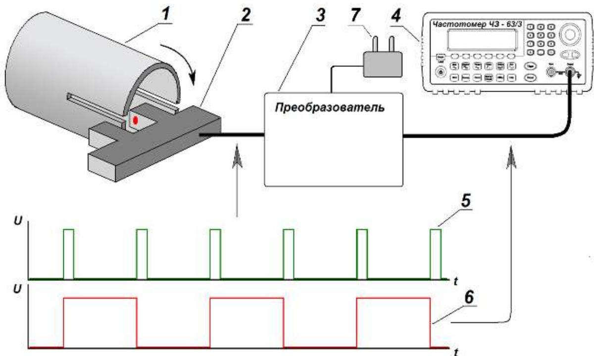
1 – щелевая насадка; 2 – оптопара; 3 – БФС; 4 – частотомер;
