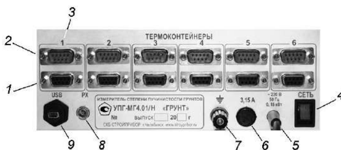
б) задняя панель блока управления
