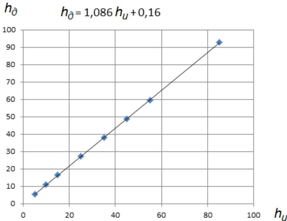
$h_u$  – измеренное значение толщины выполненное по базовой характеристике АП(А400);  $h_{\partial}$  – действительное значение толщины
