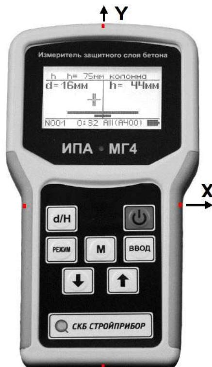
Рисунок 1 – Общий вид измерителя ИПА-МГ4.02
