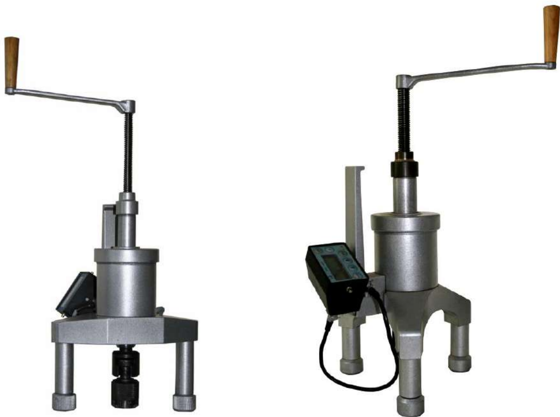
Рисунок 1.в - Общий вид приборов ПСО-100МГ4А
