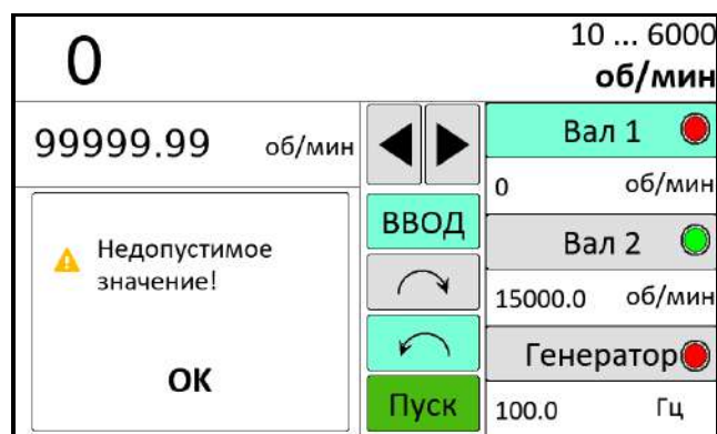
Рисунок 6 – Вид дисплея при вводе значения частоты вращения вне диапазона для данного вала
