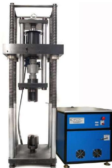
Рисунок 4 – Общий вид машин МСВ-МГ4М
