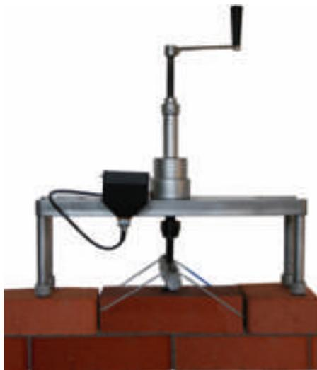
**КОМПЛЕКТ ПОСТАВКИ:** силовозбудитель с вилочным захватом, электронный блок, упаковочный кейс (сумка), кабель связи с ПК, CD с программным обеспечением, руководство по эксплуатации с методикой поверки.
