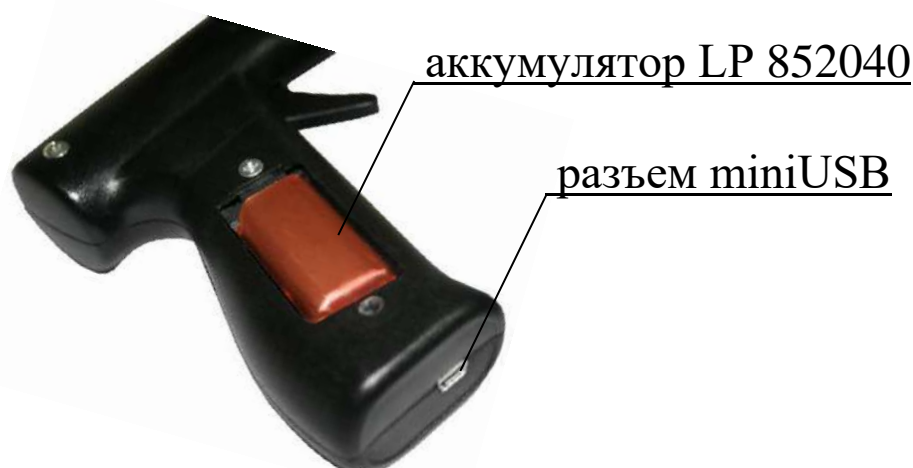
Рисунок 1.2 – Вид рукояти преобразователя
