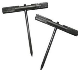
Рисунок 10 - Приспособления для крепления сейсмоприемников на грунт
