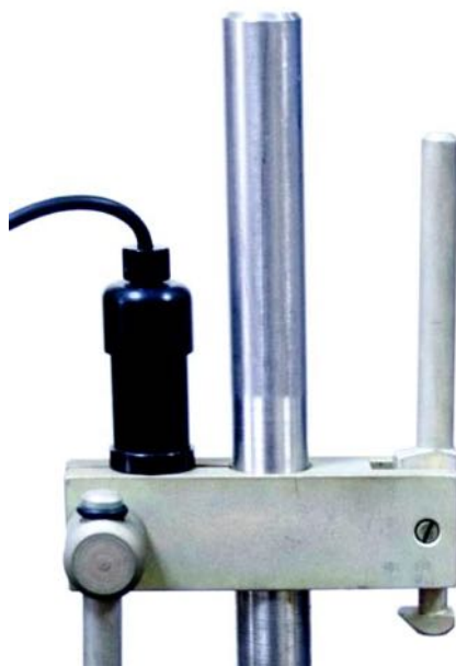
Рисунок ПБ.4 – Установка сейсмоприёмника на темпер
